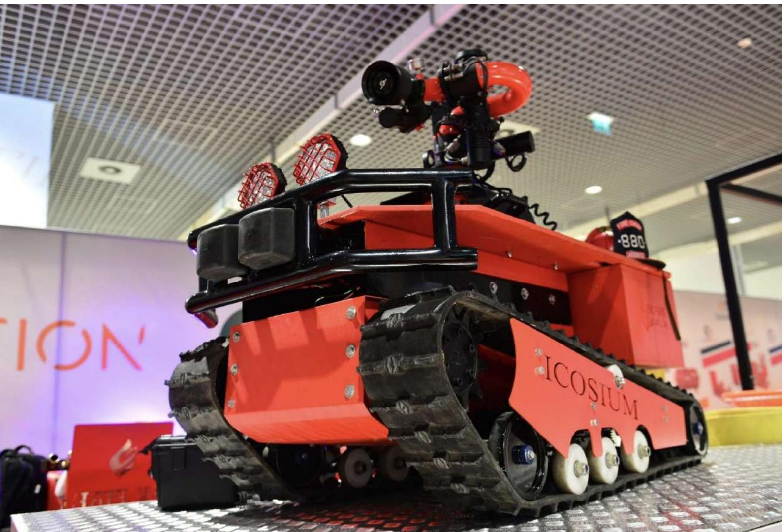
Equipado com inteligência artificial avançada e uma câmara térmica, o robô consegue localizar fontes de fogo e detectar siluetas humanas ou pessoas feridas.
