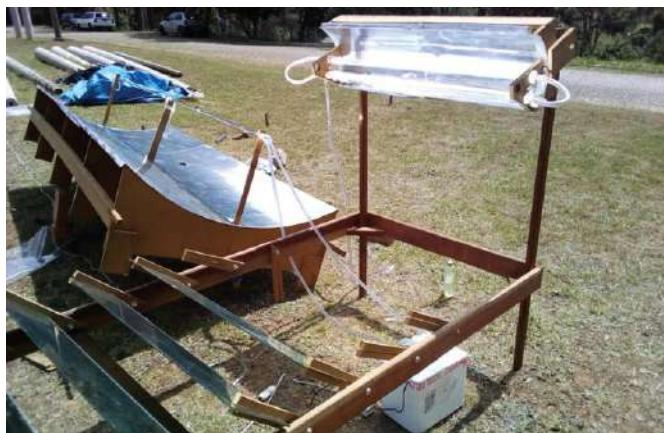
"O promissor protótipo poderá ser instalado no local de captação da água, ou seja, numa represa por exemplo, sem necessidade de energia eléctrica. Em fluxo contínuo permite disponibilizar de 1 a 5 litros de água potável por minuto", o que significa que em 24h, têm-se, em média, 7 mil litros de água potável.
